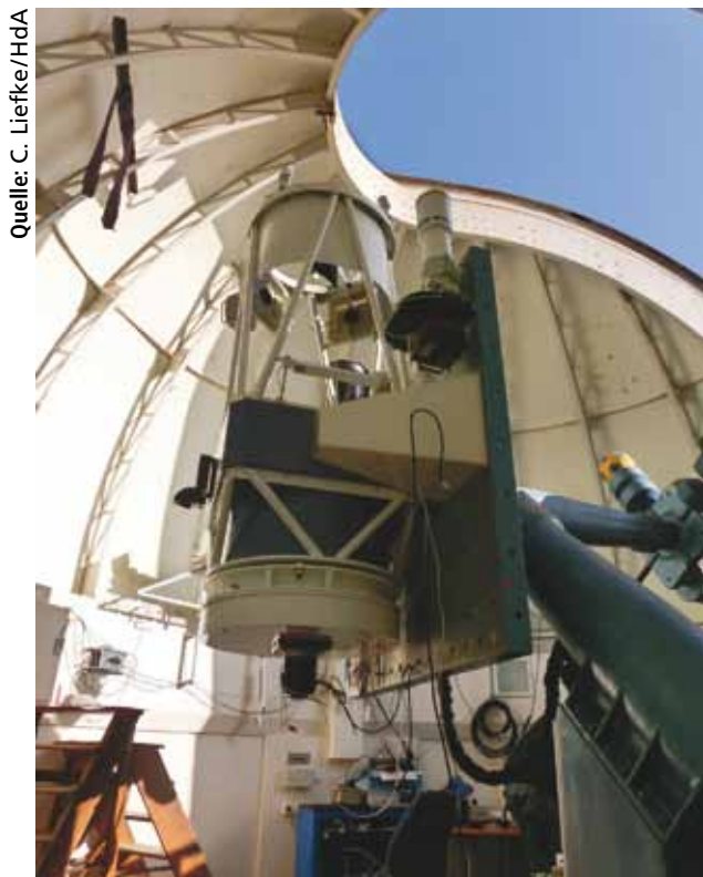
Abb. 7.4: Das fernsteuerbare ROTAT-Teleskop der Stiftung Interaktive Astronomie und Astrophysik in seiner Kuppel am Observatoire de Haute Provence. Es wird im Rahmen einer Kooperation auch von Praktikanten und Partnerlehrern des HdA genutzt. Das Hauptteleskop hat einen Durchmesser von 60 cm und ist mit einer großformatigen CCD-Kamera ausgestattet. Hinzu kommen mehrere kleinere Begleitteleskope, unter anderem ein Refraktor für Weitfeldaufnahmen.
