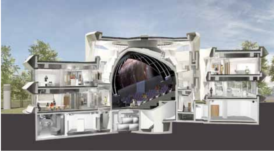
Abb. 3.4: Vertikaler Ost-West-Schnitt durch das Haus der Astronomie, Anblick von Norden. Im Untergeschoss sind Haustechnik und Laborräume untergebracht.
