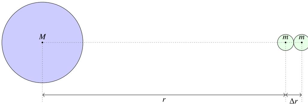
Links ist die große Masse  $M$ , die beiden Massekugeln rechts haben jeweils die Masse  $m$ . Der Abstand des Mittelpunkts der inneren Massekugel vom Mittelpunkt der Masse  $M$  sei  $r$ . Der Mittelpunkt der äußeren Massekugel rechts ist um  $\Delta r$  weiter entfernt als das. Entsprechend der Formel (7) ist die Stärke der Gezeitenkraft, die versucht, die beiden Kugeln auseinanderzuziehen,
