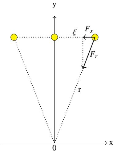
Bei diesen beiden Bällen ist der Gezeiteneffekt geometrisch. Wie in der Abbildung links dargestellt fallen beide Bälle, die jeweils um  $\xi$  horizontal zur senkrechten y-Achse verschoben sind, auf den Massen-Mittelpunkt zu, der hier als Nullpunkt des Koordinatensystems gewählt wurde. Der radiale Abstand des rechten Balls vom Nullpunkt ist in erster Näherung gleich  $r$ , also gleich dem Abstand des mittleren Balls vom Nullpunkt.
