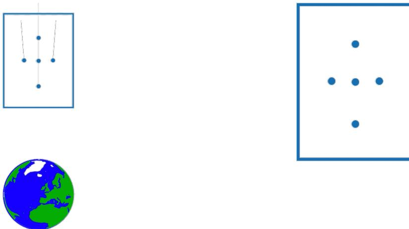
Aufgrund der unterschiedlich starken bzw. in unterschiedliche Richtungen wirkenden Gravitationskräfte verschiebt sich die zunächst symmetrische Anordnung fallender Bälle. Im folgenden wollen wir diese Gravitationskraft-Differenzen quantitativ beschreiben. Fangen wir mit den Bällen an, die horizontal gegenüber dem mittleren Ball verschoben sind.
