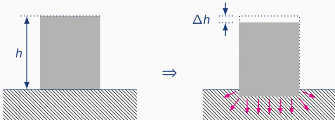
Energie nötig, um an der Basis Volumen von  $F \cdot \Delta h$  zu verflüssigen,
