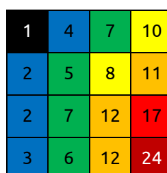
Abbildung 3: Falschfarben-Höhenkarte der simulierten Messung. Die Verteilung der Farbwerte entspricht dem Koordinatengitter der Messpunkte. Die Farben entsprechen den Zahlengruppen 2-4, 5-7, 8-10, 11-13, usw.
