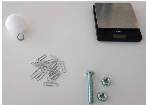
**Figure 8** – La boule en polystyrène et ses poids. On pèsera les différents éléments à l'aide d'une balance numérique. (Image : M. Nielbock).
