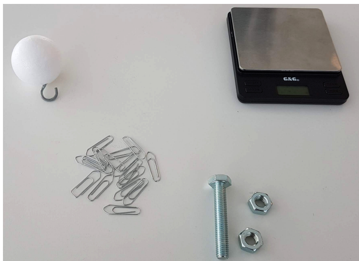
Abbildung 2: Eine Styroporkugel und Gewichte. Ihr Gesamtgewicht – gewogen durch eine Digitalwaage – soll im Experiment den Auftrieb im Wasser ausgleichen (Bild: M. Nielbock).
