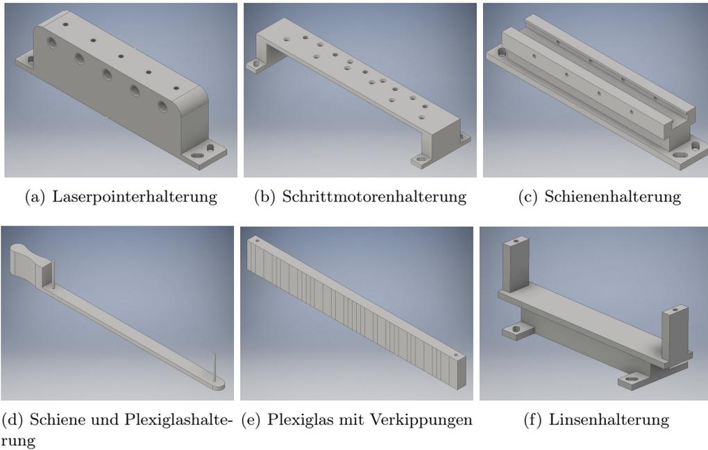
Abbildung 30: Auswahl der aus Aluminium bzw. Plexiglas gefrästen 3D-Modelle
