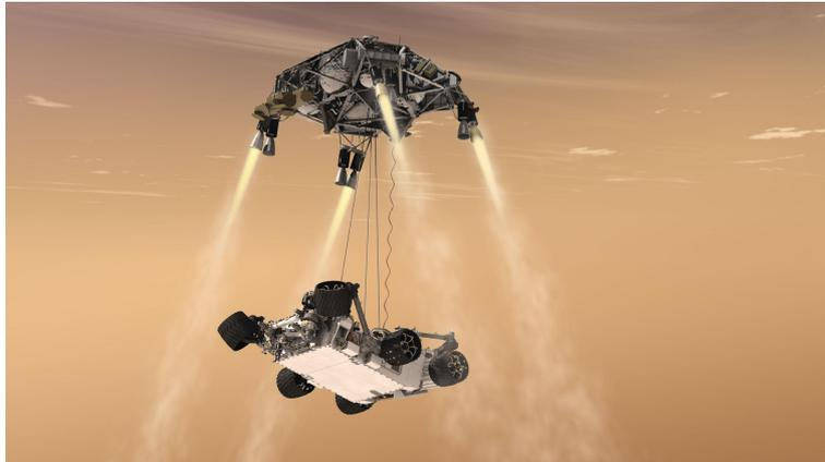
**Abbildung 1:** Künstlerische Darstellung der letzten Sequenz der Landung des Mars-Roboters „Curiosity“. Das Bremsmanöver wird nicht mit Fallschirmen, sondern mit Triebwerken durchgeführt (Bild: NASA/JPL-Caltech).
