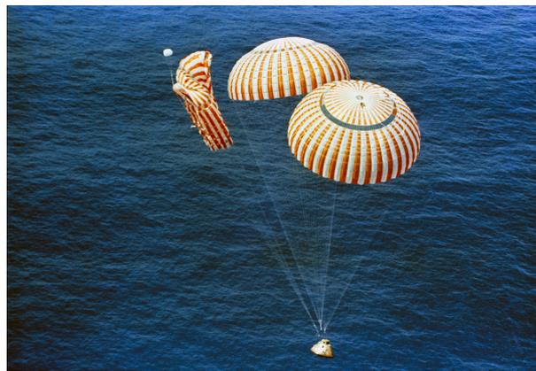
**Abbildung 4:** Die Kapsel der Apollo 15-Mission wassert mit nur zwei intakten Fallschirmen (Bild: NASA)
