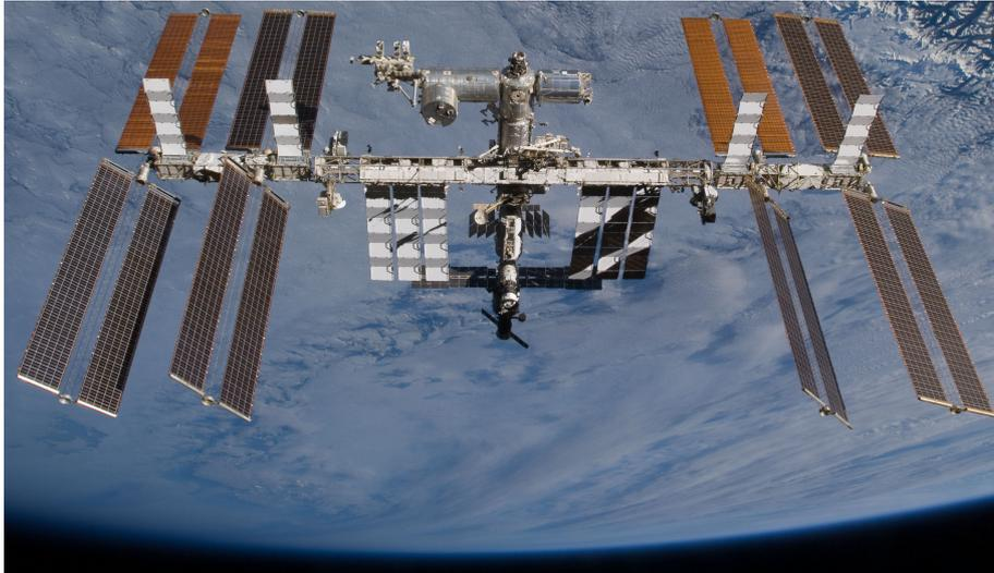
**Abbildung 7:** Foto der ISS aus dem Jahr 2009. Man erkennt die Solarmodule, die jeweils aus zwei einzelnen Kollektorflächen bestehen. Die Module drehen sich um ihre Längsachse um sich nach dem Sonnenstand auszurichten (Bild: NASA).
