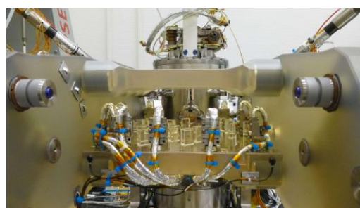
Optische Bank von LISA Pathfinder: Vorläufer eines Weltraum-Gravitationswellendetektors
