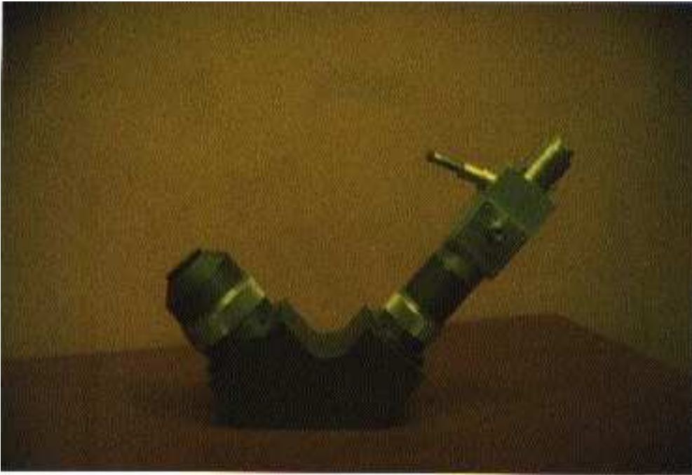
Abbildung 1.4: Hochauflösender aber unhandlicher Prismenspektrograph mit zwei Prismen zur Aufnahme von Übersichtsspektren. Präzisionsspalt, Anschluß für Spiegelreflexkamera
