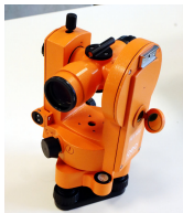
Links und Mitte: Theodolit und Sextant, eigene Bilder. Rechts: Harrisons Chronometer H5 [eigener Ausschnitt], Bild: Racklevel on English Wikipedia unter Lizenz CC BY 2.5
