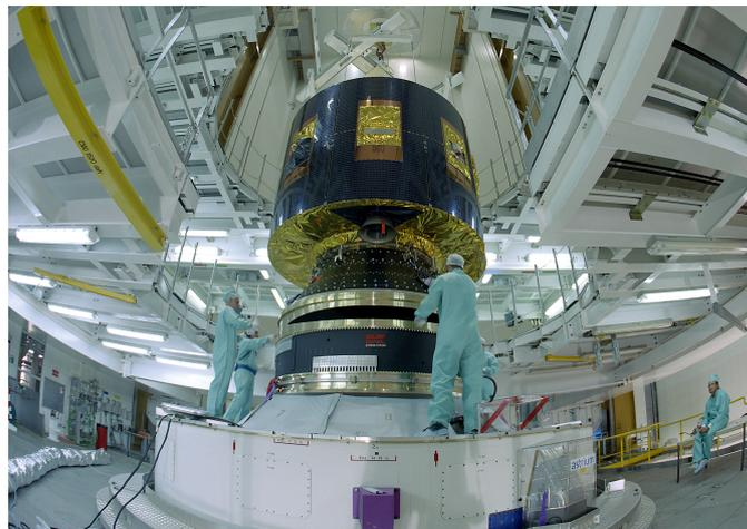
**Abbildung 12:** Der Wettersatellit MSG-1 bei der Integration in die Trägerrakete (Bild: ESA/CNES-Service Optique CSG).
