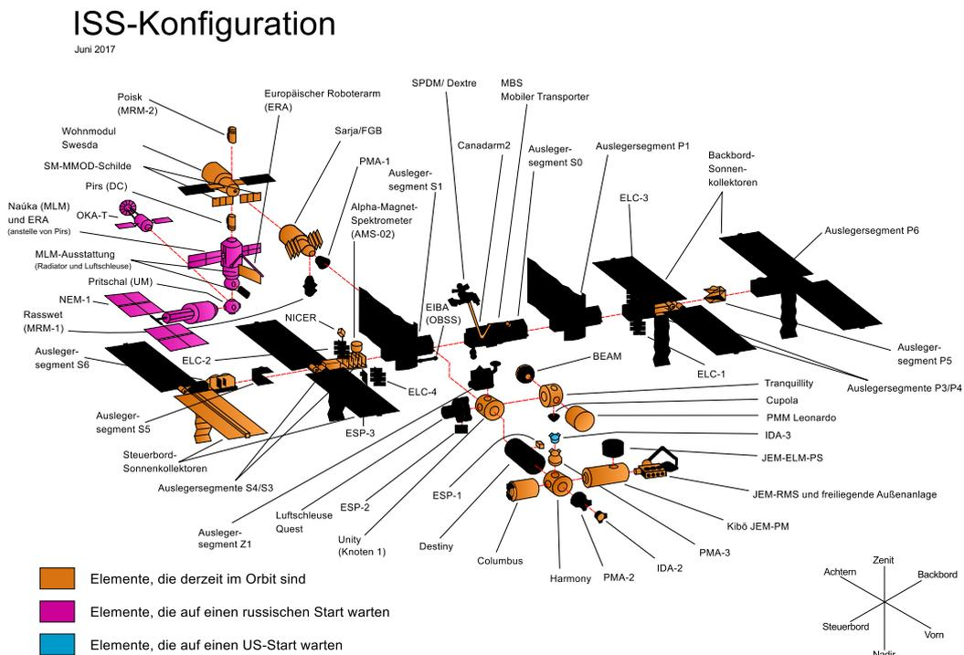
Abbildung 3: Die Module der ISS im Juni 2017 (Bild: NASA).
