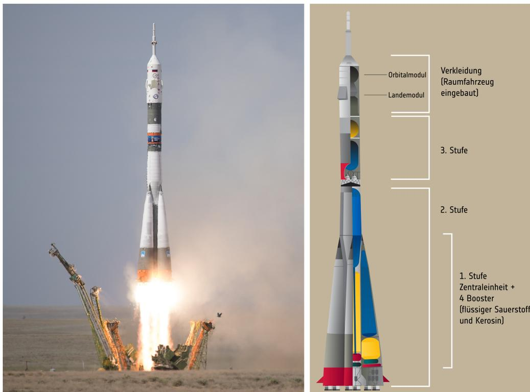
**Abbildung 4:** Links: Start der Sojus-FG-Rakete am 6. Juni 2018, mit der Alexander Gerst zur ISS flog (NASA/Joel Kowsky, <https://www.flickr.com/photos/nasahqphoto/41898551494/> (CC BY-NC-ND 2.0). Rechts: Schematische Darstellung einer Sojus-FG-Rakete, <https://www.flickr.com/photos/europeanspaceagency/35788717360/in/album-72157684209960351/> (ESA/Ausschnitt, deutsche Beschriftung: M. Nielbock).
