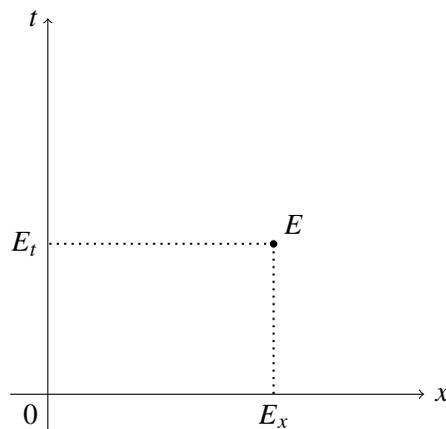
Das geht analog dazu, wie wir Punkte in ein zweidimensionales Koordinatensystem eingetragen haben: Wir laufen vom Ereignis  $E$  aus parallel zur  $x$ -Achse, bis wir auf die Zeitachse stoßen. Der Abstand des Schnittpunkts  $E_t$  vom Nullpunkt ergibt den Zeitkoordinatenwert des Ereignisses. Laufen wir stattdessen parallel zur Zeitachse bis zur  $x$ -Achse zeigt uns der dortige Schnittpunkt  $E_x$ , wie weit  $E$  vom Raumnullpunkt entfernt ist.
