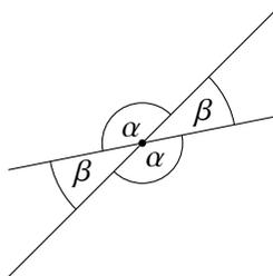
Sind die beiden Winkel gleich,  $\alpha = \beta$ , dann stehen die beiden Linien per Definition senkrecht aufeinander, und der entsprechende Winkel heißt rechter Winkel. Über Verfahren, Winkel zu addieren oder auch **zu halbieren** kann man Winkel auch quantitativ zueinander in Beziehung setzen.
